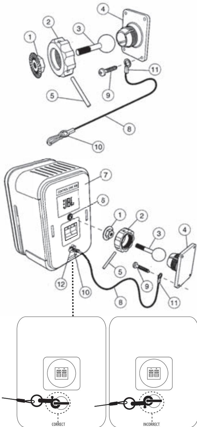
**A.** Désserrer et déposer la bague moletée (2) en la tournant dans le sens contraire des aiguilles d'une montre. Pour ce faire, utiliser au besoin la tige métallique (5) incluse en accessoire, en introduisant celle-ci dans un des trous pratiqués à la périphérie de la bague (2).
